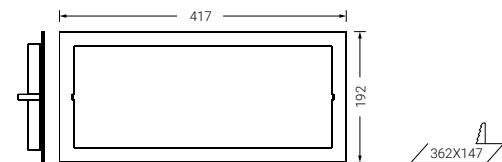
Plug in box for tube cable entry Caja enchufable para entrada de tubo visto
